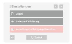
3 Folgen Sie den Anweisungen, um zuerst das Reinigungsmittel in Behälter B und dann in Behälter A zu wechseln.
